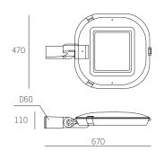
Тип крепления консоль Диаметр опоры 60 мм
